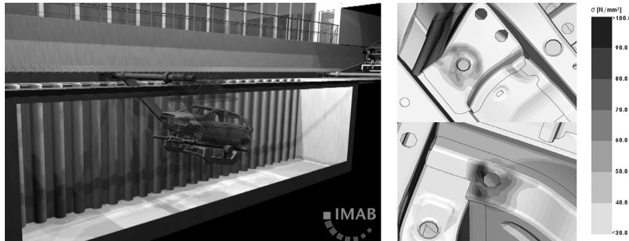
Abbildung 3: Simulation der Tauchbahn für ein Fahrzeug der Kompaktklasse
