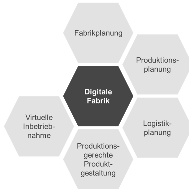
Abbildung 1: Planungssysteme der Digitalen Fabrik
