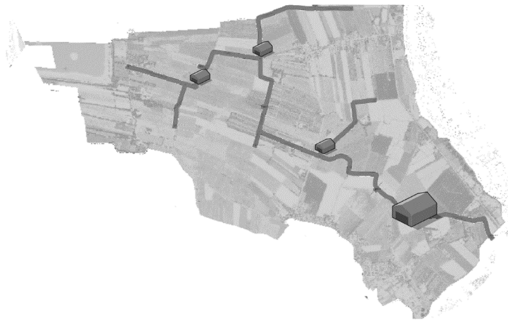
Abbildung 1: Ein Ausschnitt aus dem Gebiet des Unterhaltungsverband Kehdingen. Die Größe der Häuser repräsentiert die Leistung der Pumpe.
